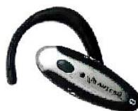
U svojoj osnovi, Bluetooth se ostvaruje mikročipom koji koristi radio prijenos kratkog dometa (nije potrebna optički vidljiva linija) za prijenos informacija. Mikročip se ugrađuje u uređaj (kamera, tipkovnica, slušalice, mobilni telefon, itd.) ili se spaja preko univerzalne serijske sabirnice (eng. USB – Universal Serial Bus), serijskog priključka ili PC kartice. Brzine prijenosa podataka su do 1Mbps, a efektivna brzina
