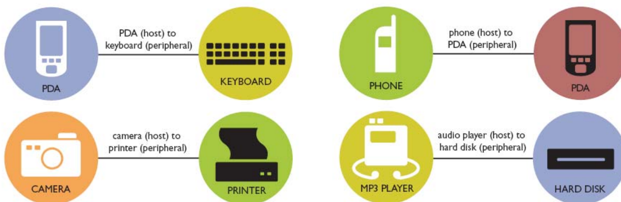
SI.9. Primjeri spajanja uređaja USB OTG-om
