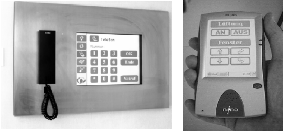
Slika 5. Uređaji za kontrolu i upravljanje EIB sustava
