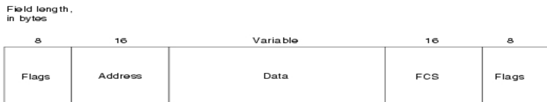
Slika 5. Osnovni format Frame Relay okvira
