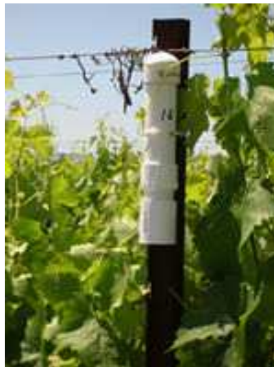
Slika 4.2 Čvor senzorske mreže za motrenje vinograda
