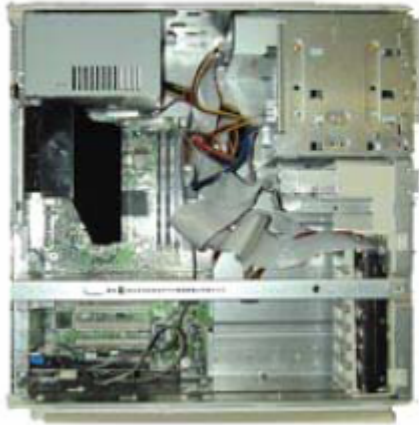
Sl. 1. Usporedba upotrebe PATA i SATA kablova
