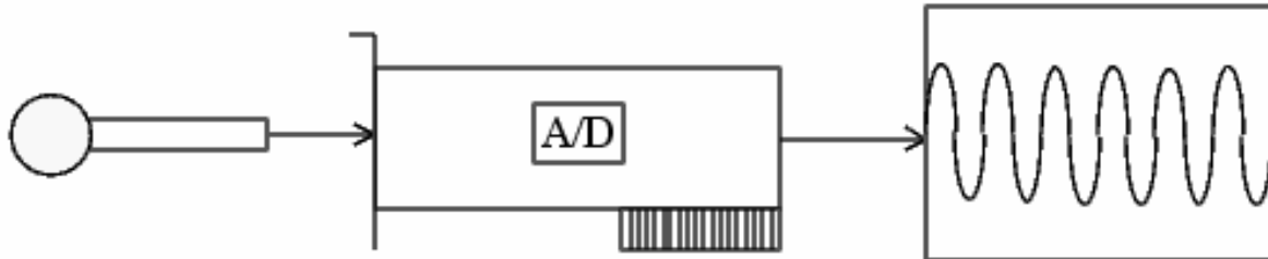
Slika 1. Korištenje zvučne kartice kao A/D pretvornik
