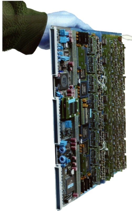
Slika 9. CEA DAPNIA SAPHIR modul za detekciju fizijskih fragmenata
