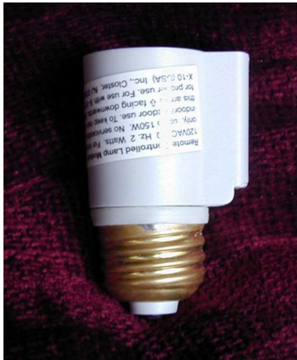
Slika 2 - X10 modul kojim se upravlja rasvjetom
